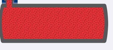
Fülllänge ist abhängig von statischer Druckhöhe und Fließfähigkeit des Materials
