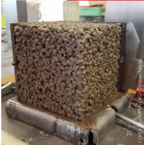
Laborüberwachung von Pervia®
