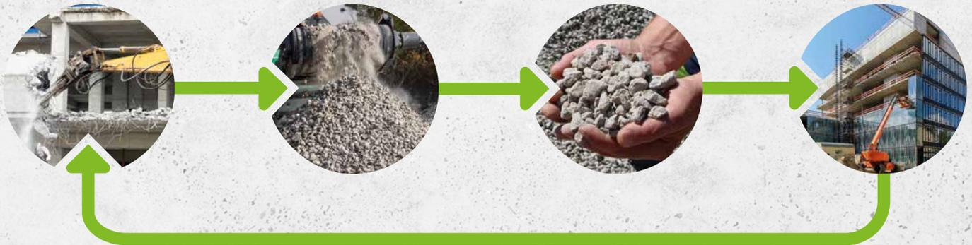
R-Betone enthalten Gesteinskörnung aus fachgerecht aufbereiteten mineralischen Bauabfällen, im Wesentlichen Betonbruchstücke, die in Brechern und Prallmühlen auf die benötigten Korngrößen gebracht wurden – Beton ist ein grundsätzlich immer wieder recycelbares Material.
